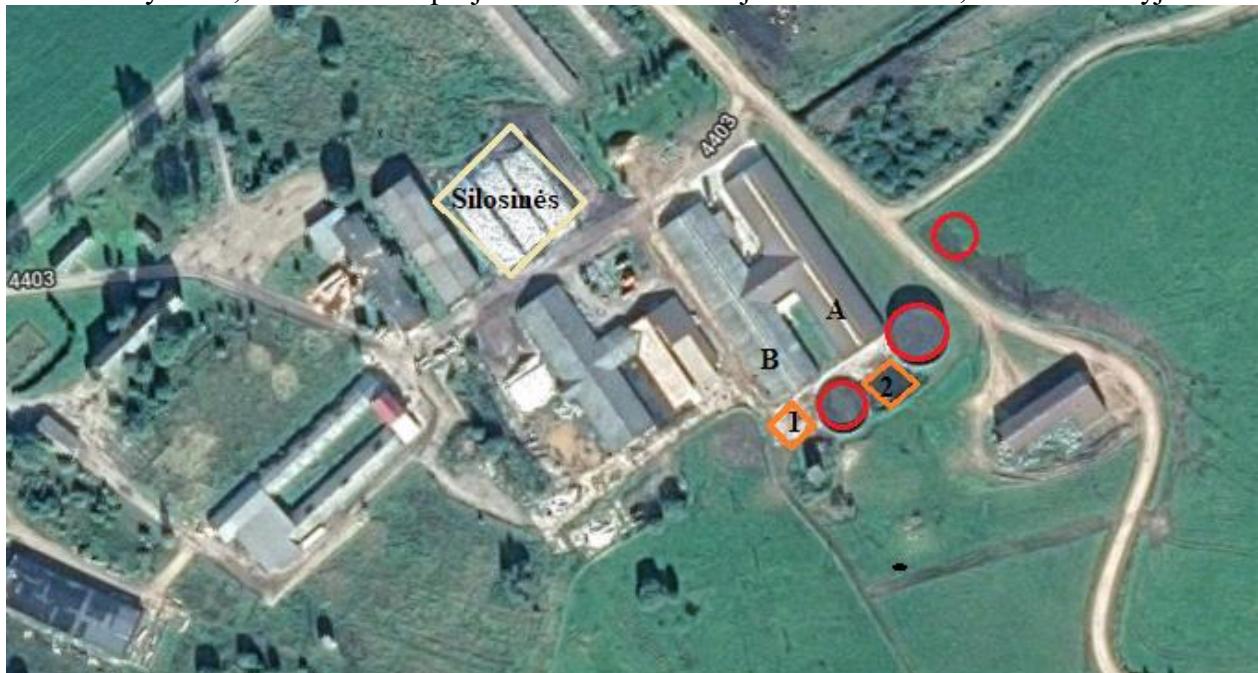
2 pav. Tiršto mėšlo mėšlidės Nr.1 ir Nr.2 išdėstymo schema.
